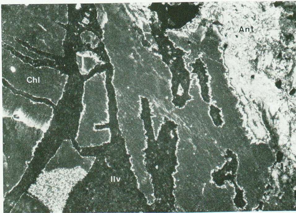
Fig. 7. Ilvait-Aggregate im Dünnschliff (Vorkommen Cotschens). In einem isotropen Chlorit-aggregat (dunkelgrau, Chl) liegen zwei Generationen Ilvaitaggregate (1. Generation: schwarz, d. h. nahezu opak; 2. Generation: hellgraue Säume, d. h. semiopak). Vergr. 51 \times mit gekreuzten Nicols.
