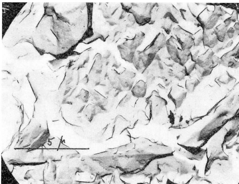
Fig. 6. Stark verzerrte Oktaeder an Flussgold (Enziwigger). Skala = 5 Mikron.
