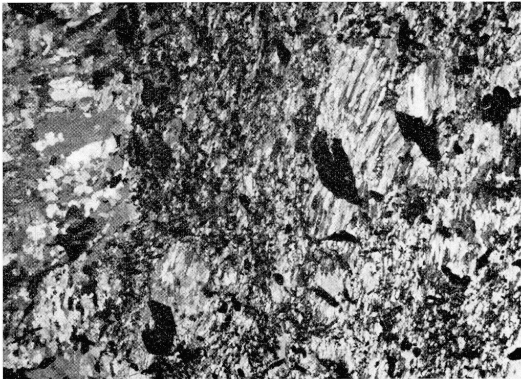
Fig. 9. Dünnschliff 1 : 10 aus einer Vererzungspartie mit drei verschiedenen Strukturbereichen des Quarzes. Links granoblastisch körnig, in der Mitte sehr feinkristallin von Karbonat und Erz durchsetzt, rechts lamellar (parallel einem Hauptrhomboeder?). Deutlich grössere Arsenkieskristalle.
