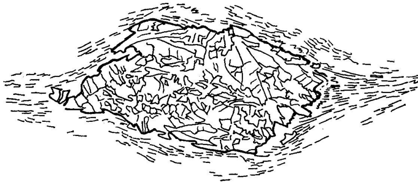
Fig. 8. Lawsonitpseudomorphose, leicht deformiert, besteht aus Zoisit, wenig Epidot und Chlorit in geregelter Grundmasse von Diablastik. (PVB 1127) Vergr. 10 × .
