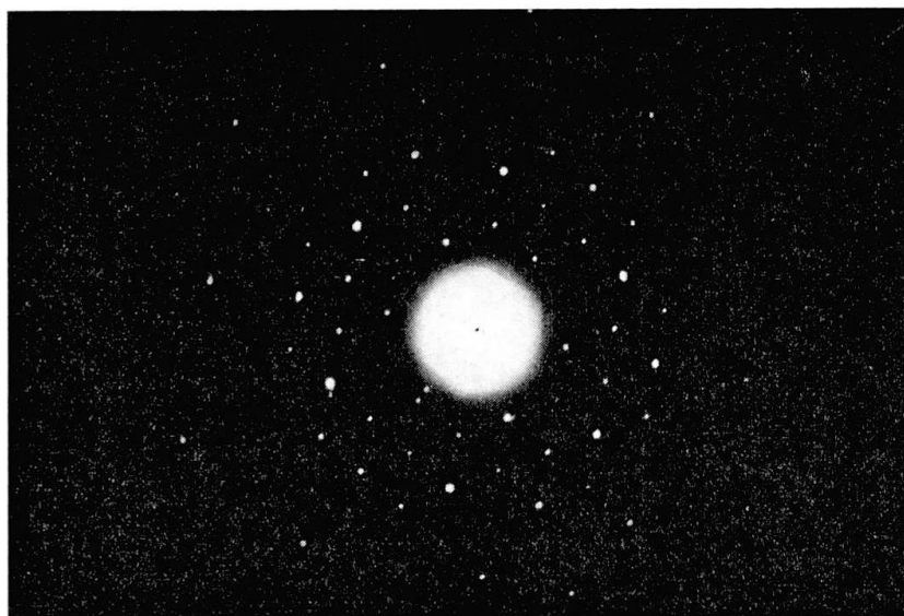
Fig. 6. Cliché de diffraction électronique de la lithiophorite, obtenu par un faisceau normal au clivage (001).
