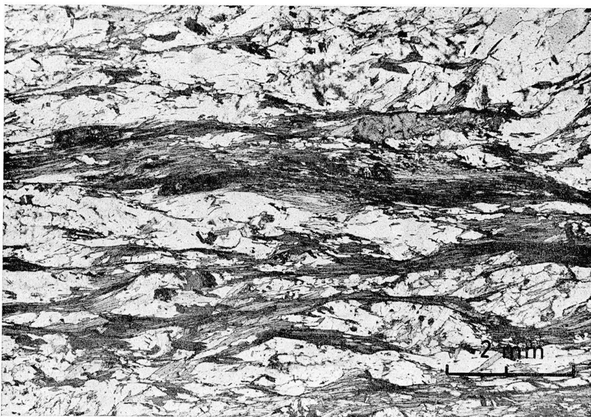
Fig. 8. Microfotografia di feltri di sillimanite fibrolitica disposti lungo i lettini di biotite. Campione 183. Luce naturale.
