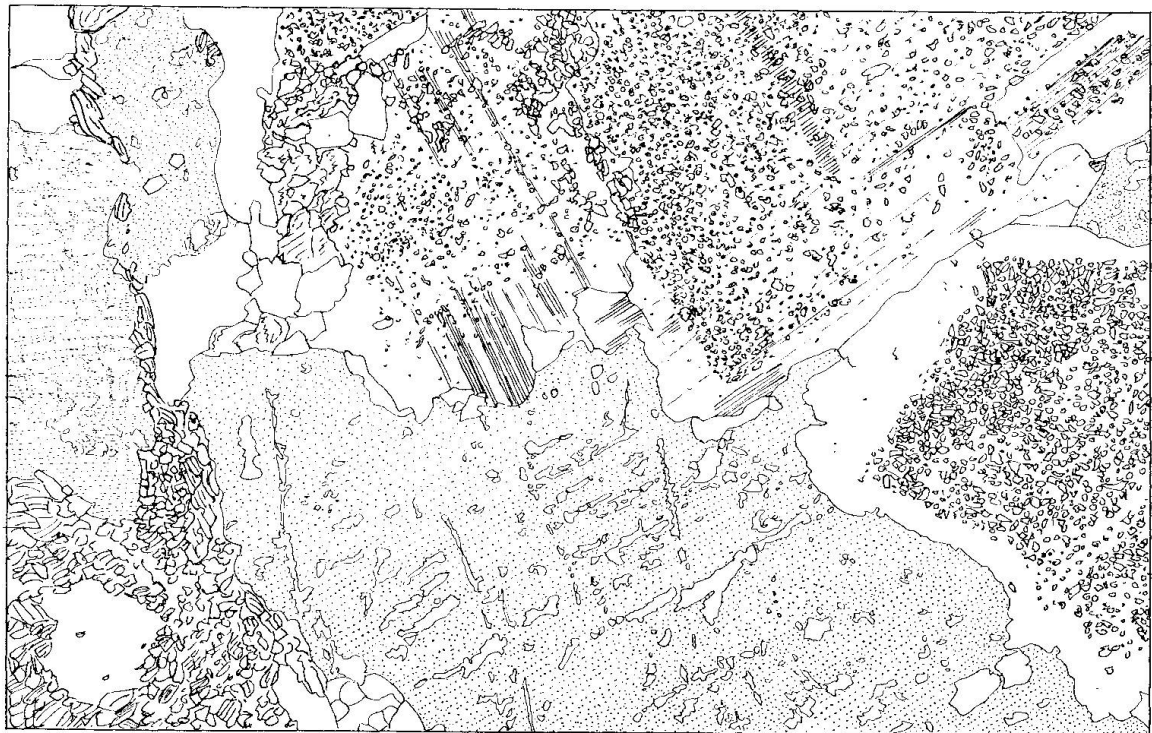
Fig. 4. Dünnschliffskizze einer Zentralen Aaregranitgneis-Probe mit saussuritisiertem Plagioklas (= Albit mit Einschlüssen von Phengit und Epidot), perthitischem Kalifeldspat und links im Bilde einem Haufwerk von Phengit, Biotit und Epidot, welche auf einer Scherzone neu kristallisiert sind.
