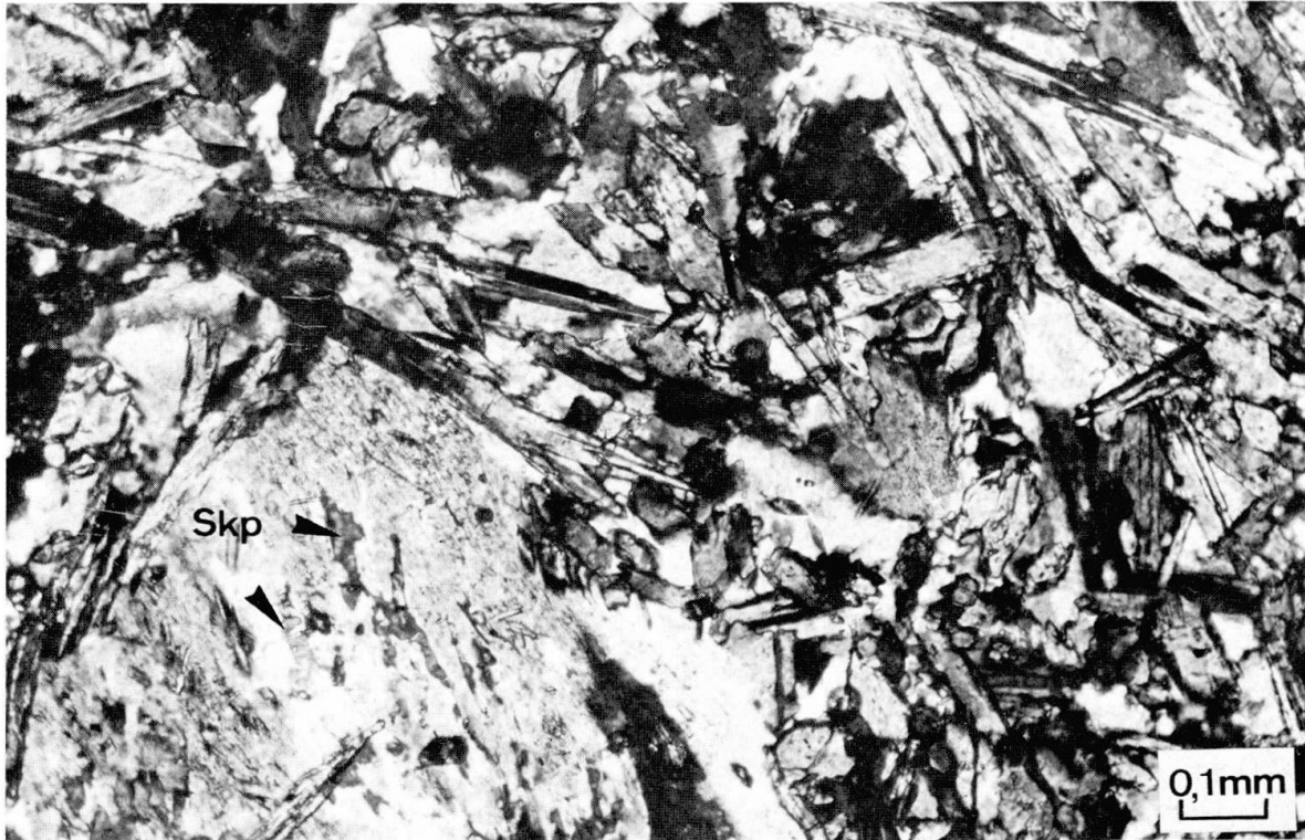
Fig. 4a: Die durch die Kontaktmetamorphose instabil gewordenen magmatischen Plagioklase reagieren vorerst zu Albit, Epidot, Calcit und Skapolith (Skp). Das intersertale Plagioklasgefüge wird zerstört. X Nic.. (Cima del Duca, P5).
