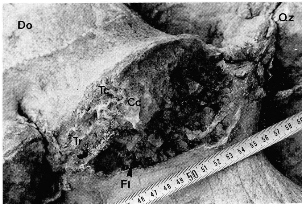
Fig. 8 Settore H, alternanza di lenti di quarzo e fluorite in un'unica struttura.
