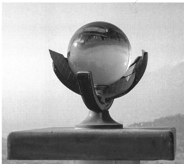
Fig. 3 - L'eliografo (registratore del soleggiamento) della ditta Negretti & Zambra di Londra, installato alla stazione di Lugano nel 1864.
