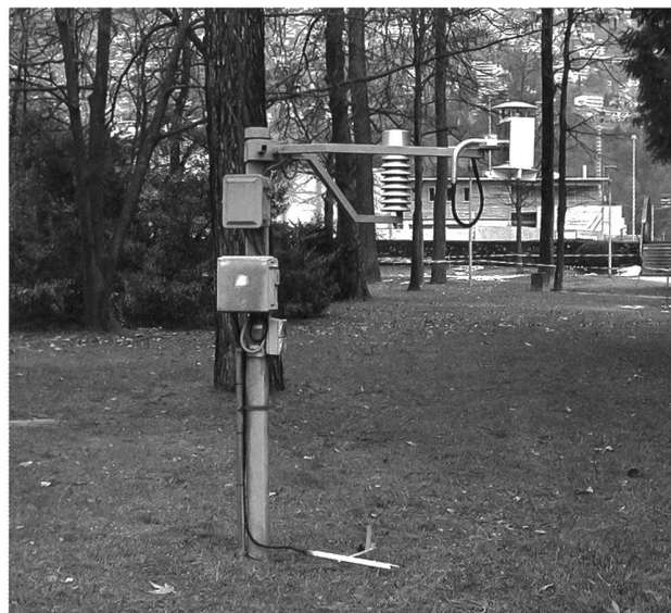
Fig. 11 – La parte della stazione automatica ASTA nel Parco Ciani, tra il 1978 e il 2008. Sul palo sono installati i sensori della temperatura e dell'umidità dell'aria, mentre la sonda sul prato rileva la temperatura a 5 cm sull'erba (foto archivio Centro meteorologico regionale).
