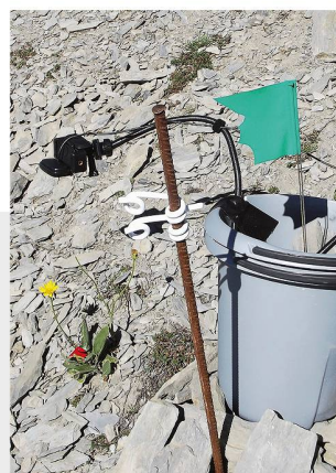
Il sistema di monitoraggio automatico impollinatori Rana in azione mentre osserva un capolino di S. doronicum nella popolazioni con citotipi multipli di Tête Grosse (SO Francia) (foto: Luca Pegoraro).
