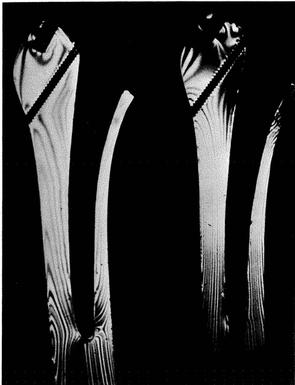
Abb. 2. Spannungsoptik des proximalen Femur-endes unter Belastung a) mit Metallprothese, b) mit isoelastischer Prothese.
