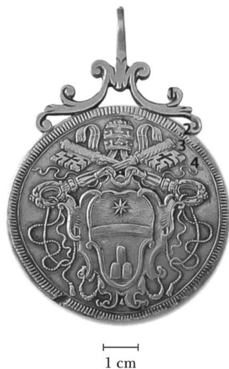
Fig. 5 Campione 456. Localizzazione dei punti di campionamento: 1. montatura abrasa; 2. brasatura; 3. pasta moneta abrasa; 4. pasta moneta tal quale.
