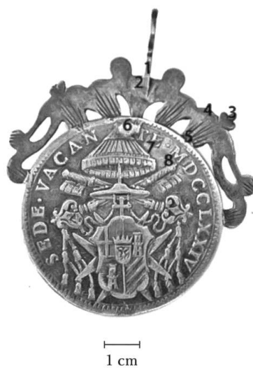
Fig. 6 Campione 458. Localizzazione dei punti di campionamento: 1. appiccagnolo abraso; 2. brasatura di collegamento tra appiccagnolo e montatura; 3. montatura abrasa; 4. montatura tal quale, cioè non abrasa; 5. brasatura tra montatura e moneta; 6. foro riempito; 7. pasta moneta abrasa; 8. pasta moneta tal quale.
