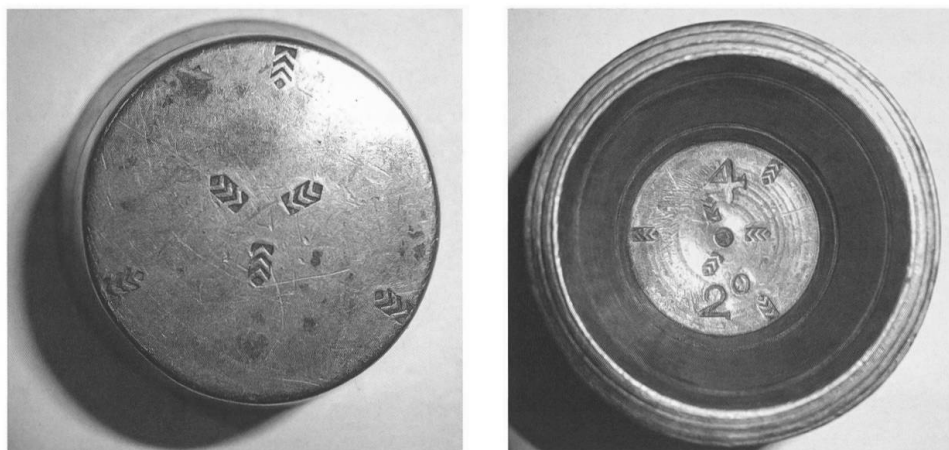
Fig. 39 Marques des chevrons à l'arrière et à l'intérieur de la pile à godets (pile n° 3 du catalogue, godet 7). Les chevrons y sont apposés en 1803. Sur la photo de droite, les chiffres 4 et 2 indiquent 4 lots ou 2 onces.
