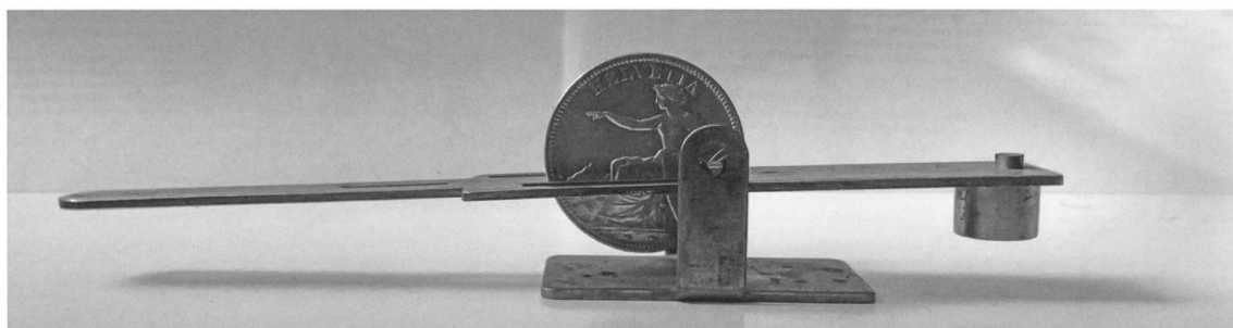
Fig. 49 Balance en acier inoxydable pour peser les pièces suisses en argent dès 1848 (L 185 mm, Coll. J.-P. Plancherel).
