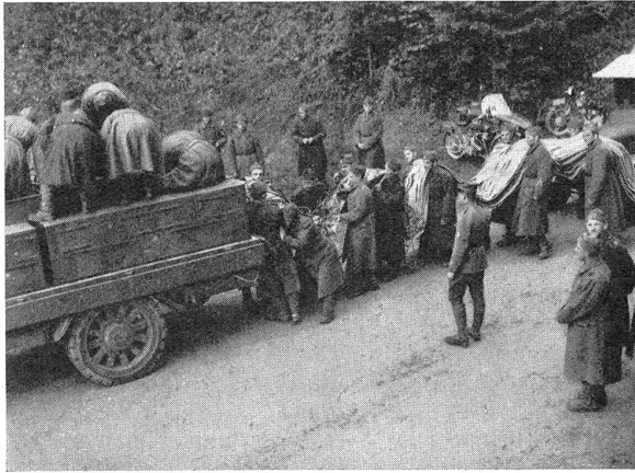
Entleerter Fessel-Ballon beim Verladen auf den Ballon-Motorwagen. Chargement d'un ballon captif dégonflé sur un camion pour ballon.
