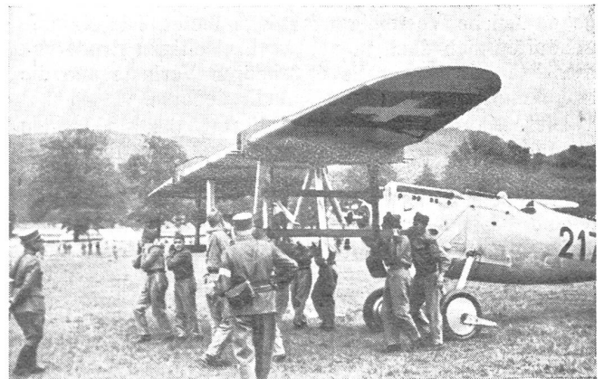
Der vollständig vom Rumpf gelöste Flügel wird abgehoben.
