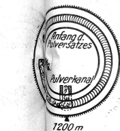
Pulversatzes in Doppelzünders. Die Leuchtzylinder wird nach der Schließung durch und mittels Stellrings an 20 eingest. Satzring links auf 120, rechts auf 4000 m gestellt.
