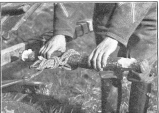
Gebrochene Waagscheite sind durch zurechtgeschützte Holzsparren zu ersetzen, die durch Tragbünd an der Waage festgemacht werden. (A N 0484.)
