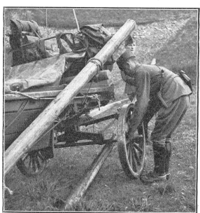
Ist ein Vorderrad unbrauchbar geworden, so ist der Schleifbaum trotzdem hinten rechts anzubringen; die Hinterräder werden nach vorne, das intakte Vorderrad nach hinten genommen. (A N 0487.)
