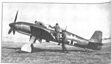
Neuer deutscher Jagdeinsitzer Heinkel 113 mit 1000 PS Leistung, 600 km/h, bei einer Steigzeit von 6,3 Minuten auf 6000 m. Bewaffnung 2 20-mm-Kanonen, 2 Mg.
