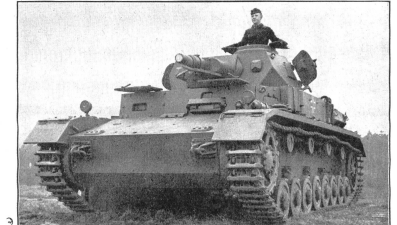
Bild 8. Schwere Panzer-Kampfwagen (5 Mann Besatzung; 6 Doppellaufräder; Bewaffnung: 1 Geschütz von min. 7,5 cm und mehrere Mg.). Fig. 8. Tank lourd (équipage 5 hommes; armement 1 canon d'au moins 7,5 cm et plusieurs mitrailleuses). Fig. 8. Carro armato pesante (5 uomini; sei ruote doppie; armamento: un cannone di cm 7,5 e alcune mitr.).
