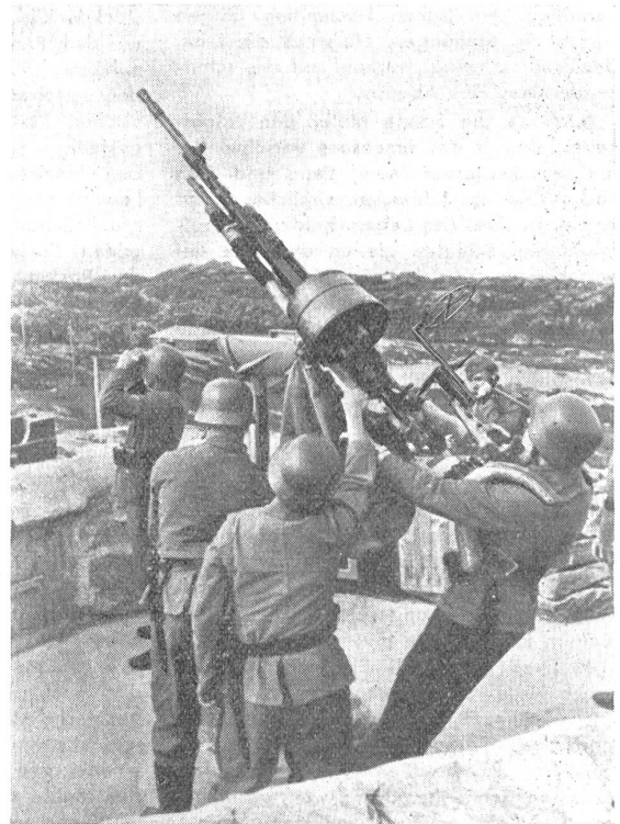
Rechts: Deutsches 20-mm-Flabgeschütz mit Trommelmagazin auf ortsfester Lafette im hohen Norden. — A droite: Canon allemand de DCA 20 mm sur affût fixe dans le haut Nord. — A destra: Cannone antiaereo tedesco da 20 mm con magazzini a tamburo montati su treppiedi fissi nell'estremo nord.
