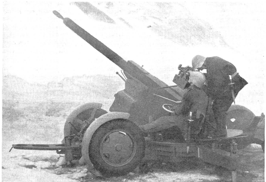
34 mm mittleres Flabgeschütz. — Canon moyen de DCA 34 mm. — Cannone antiaereo medio da 34 mm. (Zensur-Nr. VI B 1020.)
