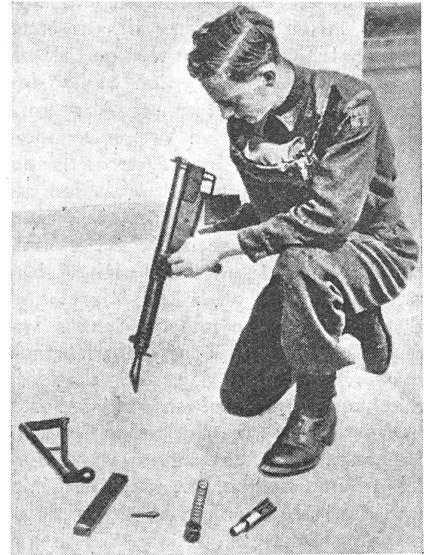
Die Hauptbestandteile der «Sten»-MP. (von links nach rechts): Anschlaggestell, Magazin, Schlagstift, Schlagfeder und Verschuß. Der Pistolenschaft ist mit einem Feuerscheindämpfer versehen.
