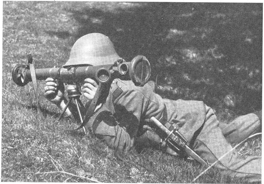
Der Telemeter ist das zuverlässigste Instrument für die Bestimmung der Schußdistanzen, es ist aber mit einem mittleren Meßfehler von 5% zu rechnen. Gegen Erdziele ist, sofern es die Zeit erlaubt, die Messung dreimal auszuführen und aus der Summe der Messungen das Mittel zu nehmen. (Z.-Nr. VI Sn 11580.)
