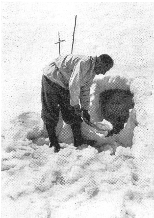
Das Bild zeigt die Arbeit mit der kombinierten Skiersatzspitze und Schneeschaukel, die bequem mitgeführt werden kann. Im Falle eines Skibruches ist sie rasch montiert, und bei Lawinenunfällen oder beim Biwakbau kann ebenso rasch der Holzstiel eingesetzt werden, um eine gebrauchsfertige Schaukel zu erhalten.
