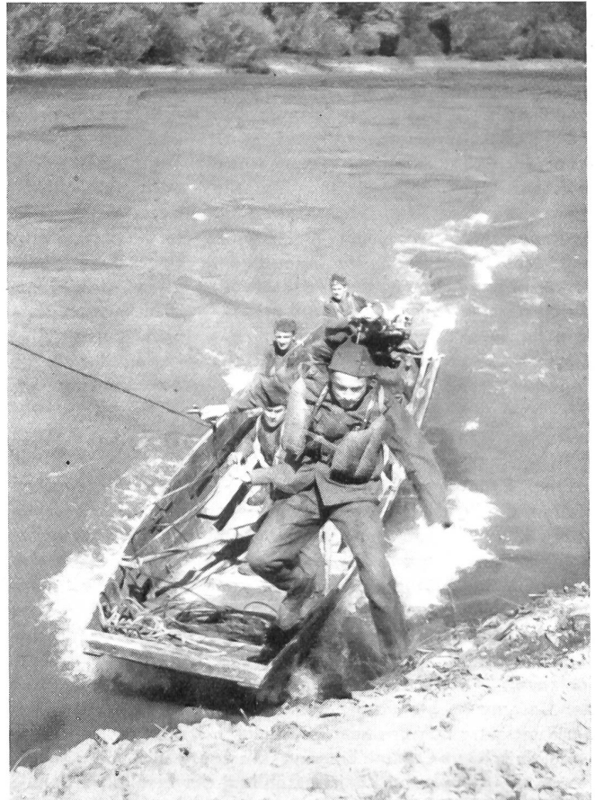
Uebersetzen von Truppen in Schlauch-Uebersetz- und Sturmbooten. Die Sturmboote sind mit einem 4-Zylinder-Kovats-Außenbordmotor (35 PS) ausgerüstet. (ATP Bilderdienst Zürich)
