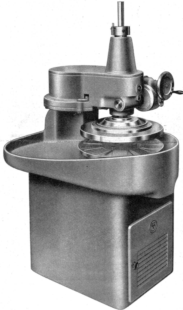
Hochpräzisions-Läppmaschine SV 560 Läppscheiben-Durchmesser . . . 560 mm Motor . . . . . 4 PS
