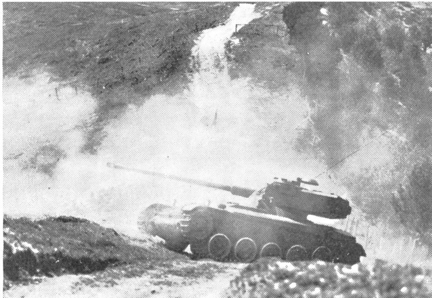
L. Pz. 51, wie der französische AMX-13-Leichtpanzer bei uns offiziell heißt, in Feuerstellung anlässlich eines Gefechtsschießens im Gurnigelgebiet. Das Geschütz kann dank dem um 360 Grad drehbaren Turm rasch in jede Richtung schießen.
