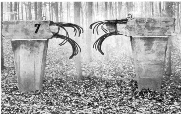
Wirkung einer V-Ladung.
