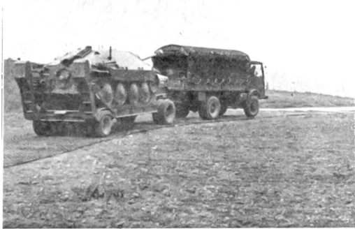
Mit Straßenbelagstafel rasch erzielte Zufahrt.
