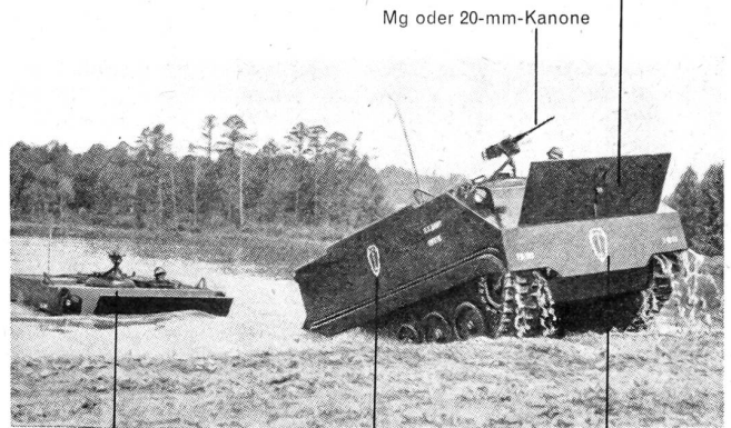
Die Fahrzeugaufbauten ragen nur 30–40 cm über Wasser und bieten somit ein schlechtes Ziel
