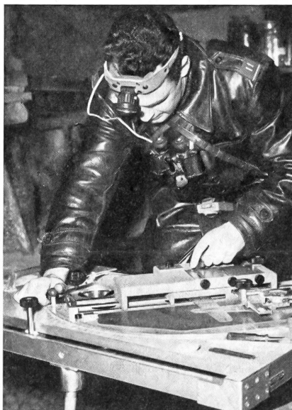
Der erfolgreiche Einsatz ist vor allem von der Schnelligkeit abhängig, mit der die Meldungen durchgehen und die Schießelemente errechnet werden. Dieser von einem Offizier bediente Schießelemente-Rechner in der Feuerleitstelle eines Artillerieregiments läßt die für die Weitergabe an die Geschütze notwendigen Zahlen innert weniger Sekunden errechnen
