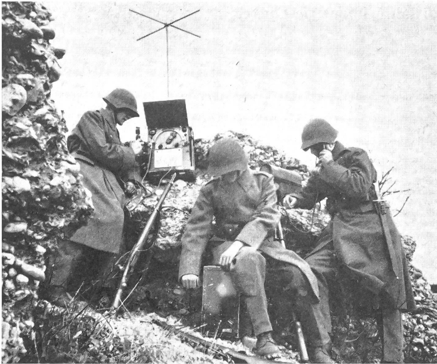
1942 | Zweite Ausführung der Patr.-Sta. der Inf. | Hier auf technisch günstigem Standort aufgestellt mit entsprechend großer Reichweite und verbunden zum Kommandoposten mit einer Tj.-Leitung. | Bereits 1942 konnte die Infanterie die improvisierte Fernbesprechung der Funkstation mittels Drahtfunk
