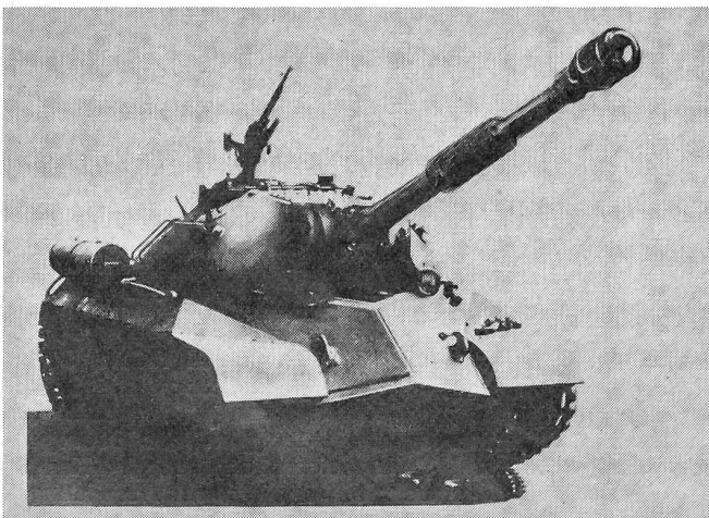
122-mm-Kampfpanzer, 55 t, T-10 , Kampfmittel der russischen Panzerdivision, mit Flab.Mg., 4 Mann, Dieselmotor, Einheitschassis der 50-t-Klasse.
