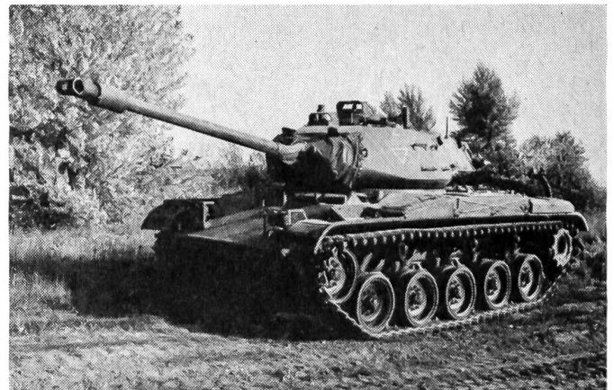
Panzer M 41, 25,4 t, lufttransportfähig; Besatzung 4 Mann
