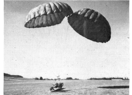
1 Der Abwurf des Kleinfahrzeuges A.S. 24, das nur 220 kg wiegt, erfolgt an zwei normalen Fallschirmen. Es kann von zwei Mann innert einer Minute einsatzbereit gemacht werden.
