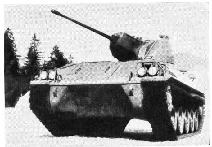
Saurer-Schützenpanzer mit 2 cm Maschinen-Kanone in Panzerhaube
