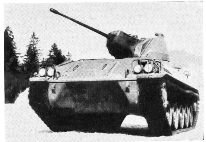
Saurer-Schützenpanzer mit 2 cm Maschinen-Kanone in Panzerhaube
