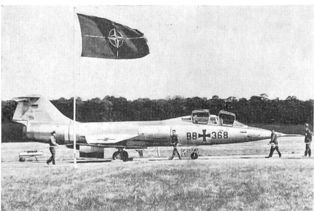
Ein «Starfighter» der deutschen Luftwaffe unter der NATO-Flagge. Dieses Flugzeug erreicht eine Geschwindigkeit von 2495 km/h.
