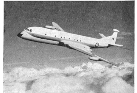
Vom Verkehrsflugzeug zum Seeaufklärer. Die vierstrahlige HS.801 Nimrod wurde aus der Comet 4 abgeleitet. Mit 4 ökonomischen Triebwerken Spey ausgerüstet, kann die HS.801 bis zu 14 Stunden über dem Meer patrouillieren. Die modernen elektronischen Detektionsgeräte an Bord werden von einer 11köpfigen Besatzung (inklusive der Piloten) bedient.
