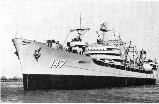
Die Versorgungseinheiten der 7. Flotte sind sehr zahlreich und umfassen verschiedene Typen. Dieser 200 m lange und 40 000 t verdrängende Tanker «USS Truckee» hat selber eine Flakbewaffnung von 1 × 12,7 cm und 12 × 7,6 cm radargesteuert. Das Schiff fasst 35 Millionen Liter Öl!
