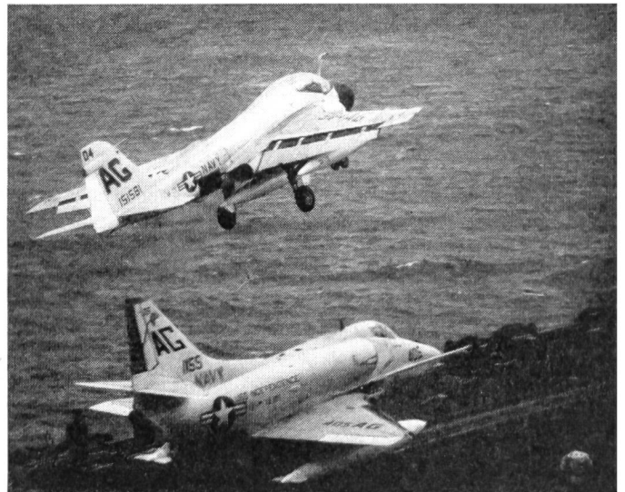
Startoperationen. Mit Bomben und Zusatztanks beladen, werden die Trägermaschinen von den Katapulten in die Luft geschleudert. Hier hat ein A-6 Intruder soeben das Deck verlassen, während ein A-4 C Skyhawk auf einen anderen (der insgesamt vier) Katapult auf den «Abschuss» wartet.
