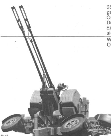
35-mm-Zwillings-Fliegerabwehrgeschütz, ausgerüstet mit einer Oerlikon v₀-Messeinrichtung. Durch Messung der v₀ im taktischen Einsatz wird eine optimale Treffsicherheit gewährleistet.
