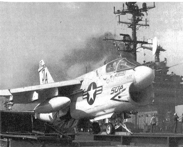
Ein Jagdbomber vom Typ A-7 A Corsair befindet sich auf dem vorderen Backbordkatapult der «USS Saratoga». Gut sichtbar ist die Befestigung des Katapultschuhs am Bugrad dieses für die Schweizer Luftwaffe zusammen mit dem italienischen Fiat-Jagdbomber in Auswahl stehenden Flugzeuges. An einer der drei Flügelaußenstationen ist ein Zusatztank aufgehängt.
