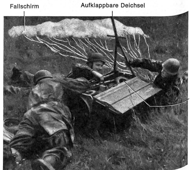
Deichsel und Räder machen aus dem Abwurfbehälter einen handlichen Karren für Waffen- und Munitionstransport. Bild rechts: Der Behälter wird geöffnet. Bild links: Die Waffen werden verteilt.
