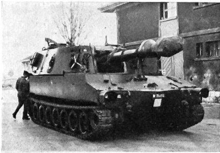
Sechs Abteilungen werden mit dieser Panzerhaubitze 66 ausgerüstet. Das Geschütz ist etwa 23 t schwer und sein Kaliber beträgt 15,5 cm. Besatzung: 1 Uof, 1 Fahrer und 6 Kanoniere.
