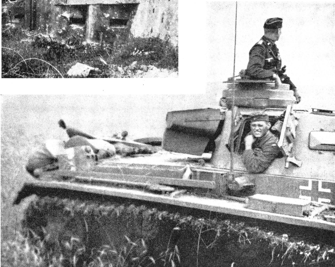
Deutscher schwerer Panzer Typ IV: 21 Tonnen, 1 Kanone 7,5 cm, 2 Mg, 5 Mann Besatzung.
