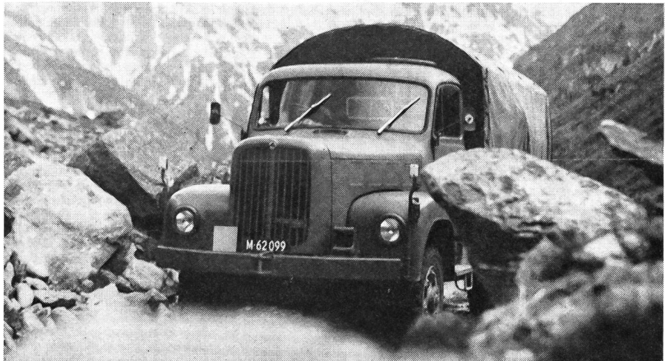
Geländegängiger Allradwagen von Saurer-Berna, Typ 2DM/2VM, seit 1964 im Einsatz als Lastwagen und Kipper.
