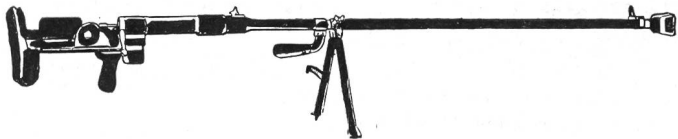
Russische Tankbüchse Degtjarew PTRS-41. Kaliber 14,5 mm. Einzellader. Gewicht 14 kg. Vo über 1000 m/s. Schussweite gegen Panzer unter 100 m, gegen Infanterieziele bis 800 m. Transport: getragen.
