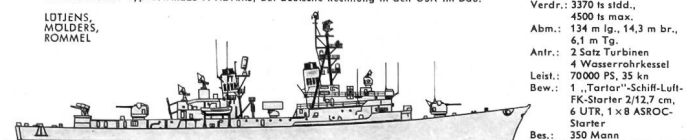
Seitenrisssskizze der neuen Flugkörper-Zerstörer der Bundesmarine mit den nötigen technischen Daten.
