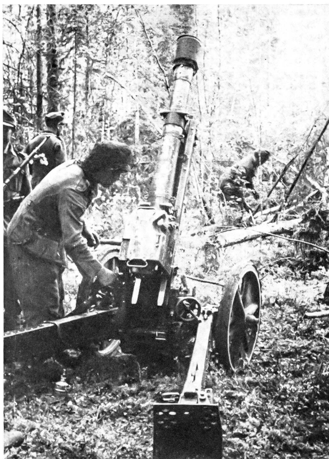
Deutsche 7,5-cm-Gebirgskanone in Feuerstellung in einem Bergwald. Beachte: Kein Schutzschild, kleine Räder, Möglichkeit für grosse Rohrerhöhung.
